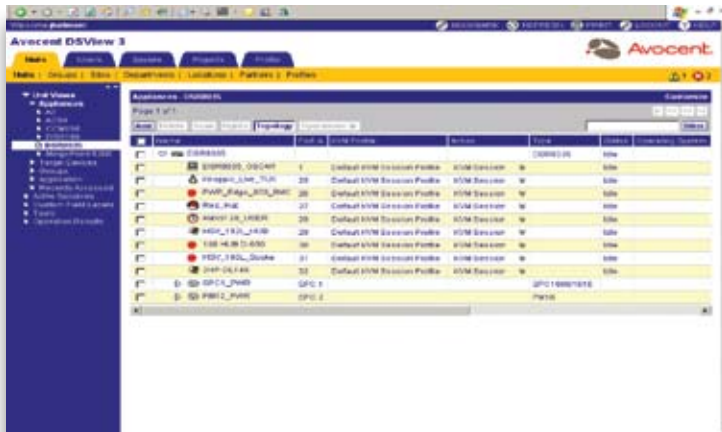
Abb. 4. Jeder an den HP-Adapter und den DSR-KVM-Switch angeschlossene Blade-Server wird als Zielgerät im Hauptfenster der DSView 3-Software angezeigt.
